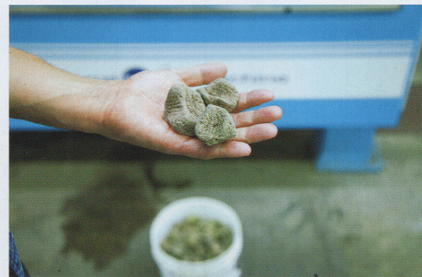
地球に優しく繰り返し使えゴミが出ないウォッシュ用の人工ストーン。
